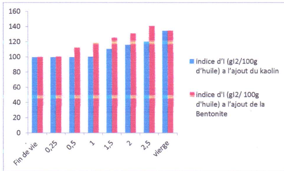
Figure III.22: Evolution de l'indice d'iode en fonction de la nature et de la masse d'argile utilisée
