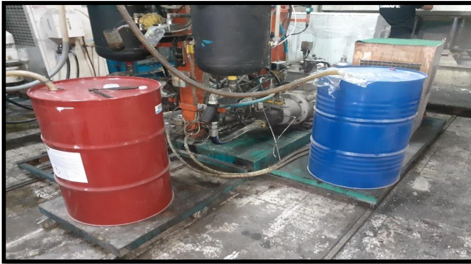
Figure II.5 : Aspiration des produits vers les cuves de la machines, futs de l'isocyanate (fut rouge) et du polyol (fut bleu).
