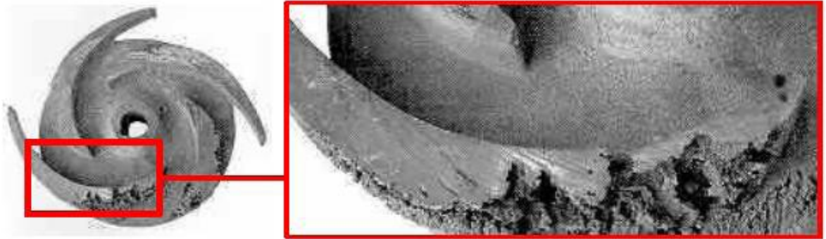
Figure (4.5) : Photo illustrant le phénomène de cavitation sur les aubes d'une pompe centrifuges [11].
