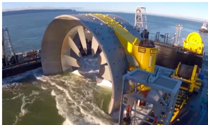
Figure I.6: Turbine OpenCenter en cours de déploiement dans le Minas Passage, Canada [source: groupe OpenHydro]
