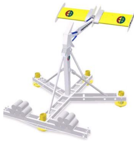
Figure I.5: Modèle 3D de la turbine hydrolienne Stingray de type hydroptère oscillant [14]
