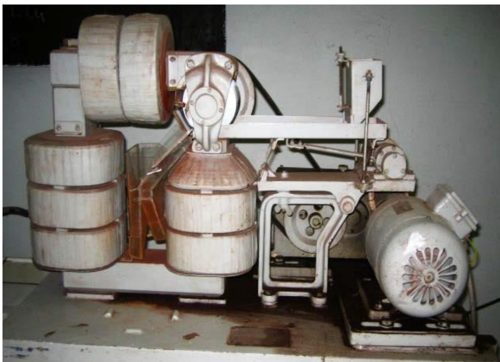
Figure 11. Séparateur magnétique à haute intensité (SMHI)
