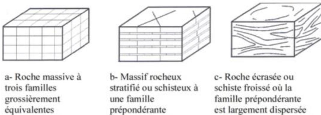
**Figure I.3.** Types de structures des massifs rocheux [03].
