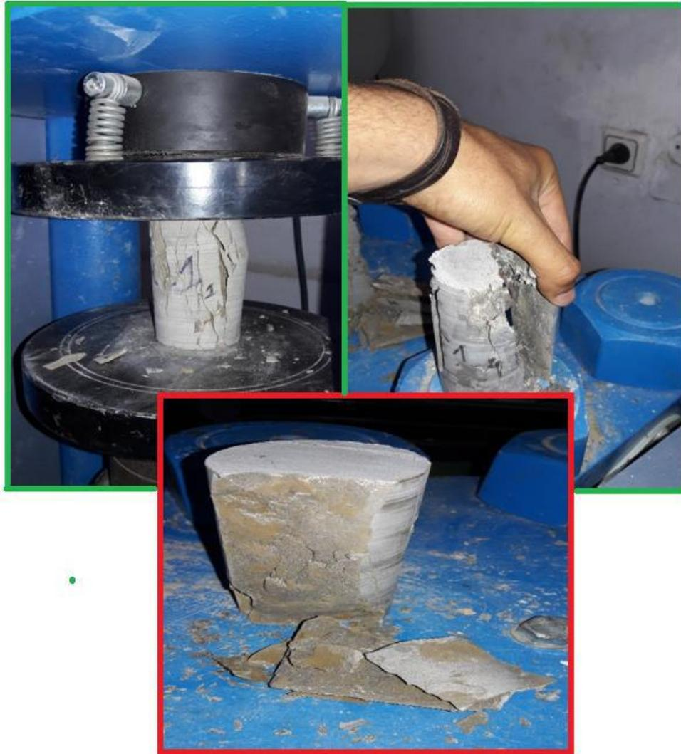
**Figure III.4:** photo de l'échantillon écrasé
