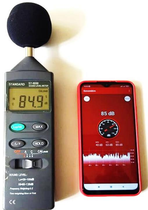
**Figure III.11** : Calibrage entre les résultats obtenus par l'instrument et l'application lors d'une essai (Source : Auteur, 2022)
