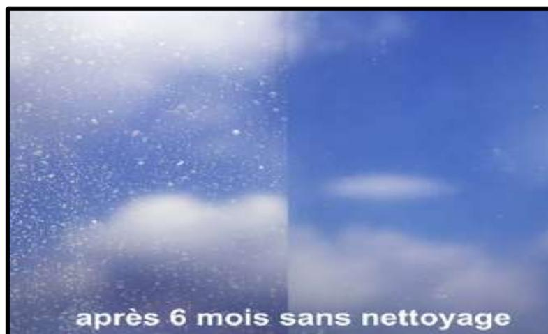
Figure II-29: La différence entre un vitrage classique et autonettoyant après 6 mois sans nettoyage. [20]
