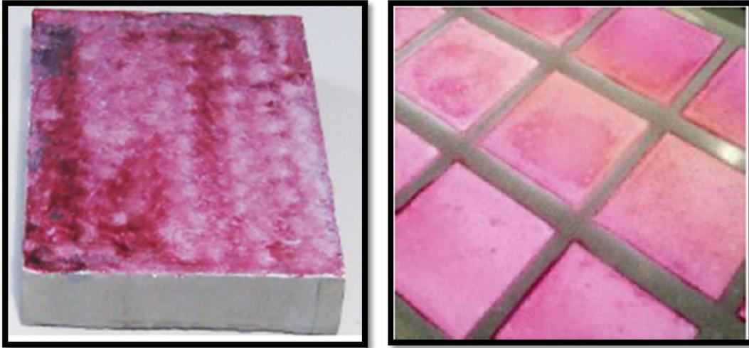
Figure II-18: Prototype d'un béton photovoltaïque avec les cellules Gratzel.
