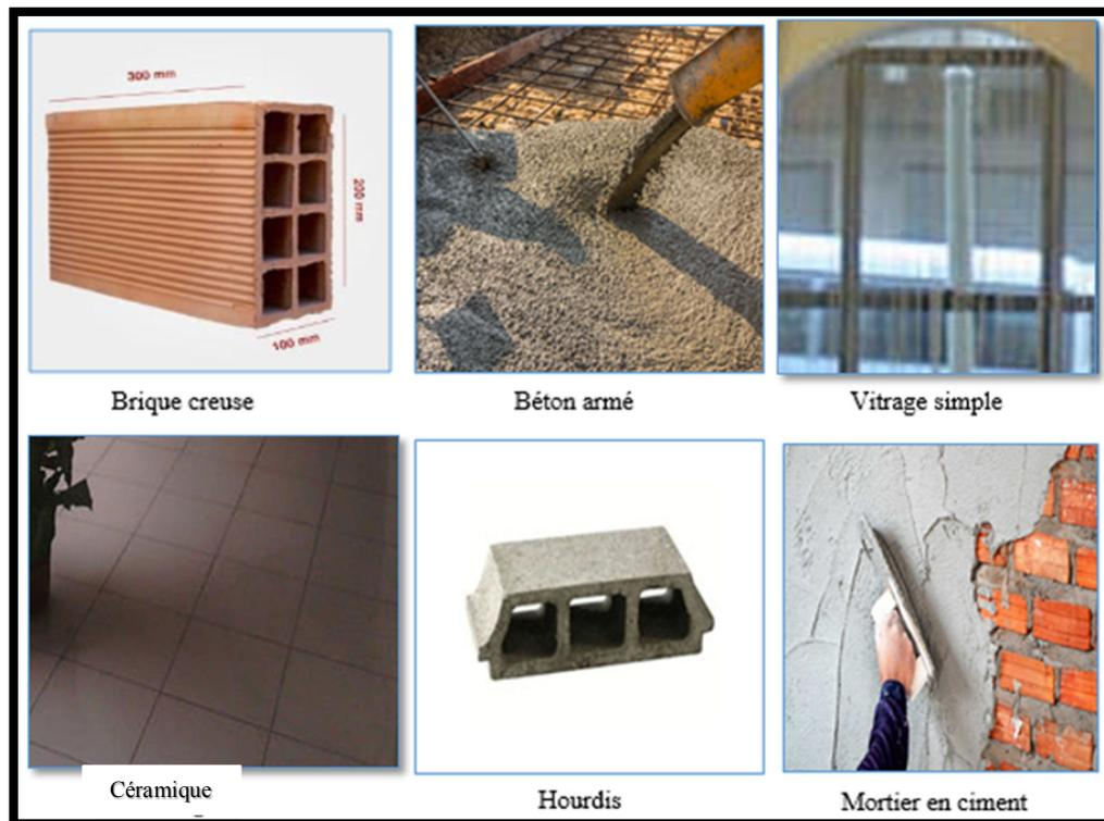
Figure III-7 : Les matériaux de base utilisés dans le cas d'étude.
