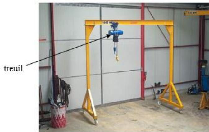
Figure I.7: treuil monter sur un portique
