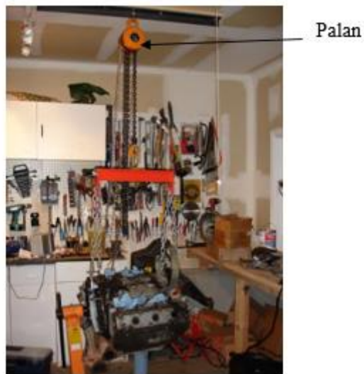
Figure I.5 : palan monter sur une potence
