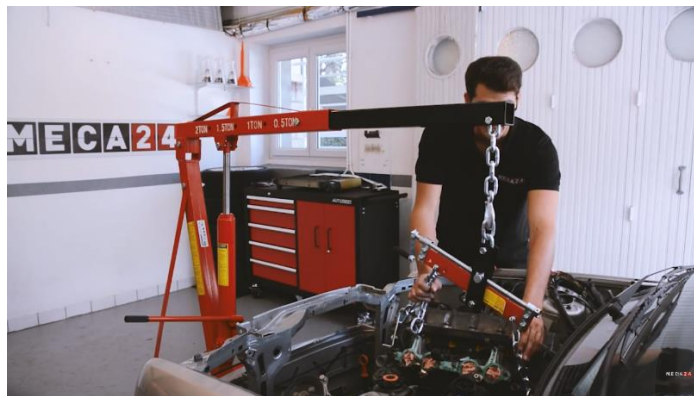
Figure I.27: positionnement de la grue d'atelier
