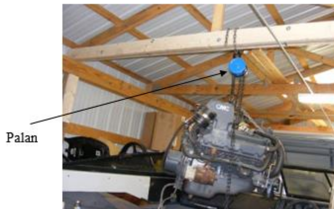
Figure I.4: palan monter sur une poutre
