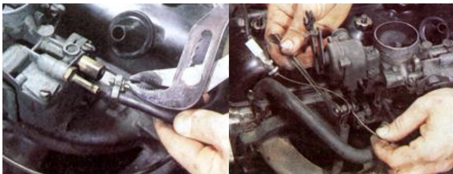
Figure I.21: démontage du système d'alimentation du carburant
