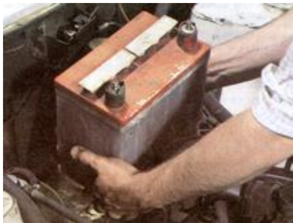
Figure I.17: enlèvement de la batterie
