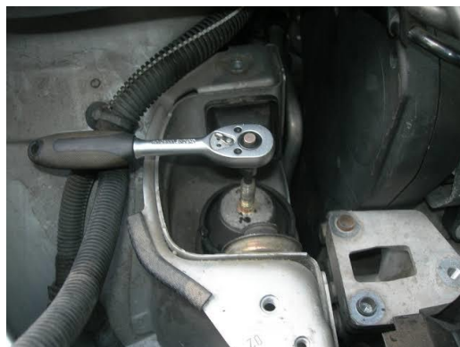
Figure I.25: démontage du support moteur
