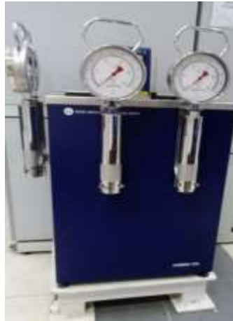
Figure III.4 : Appareil de mesure de la TVR STANHOP SETA.
