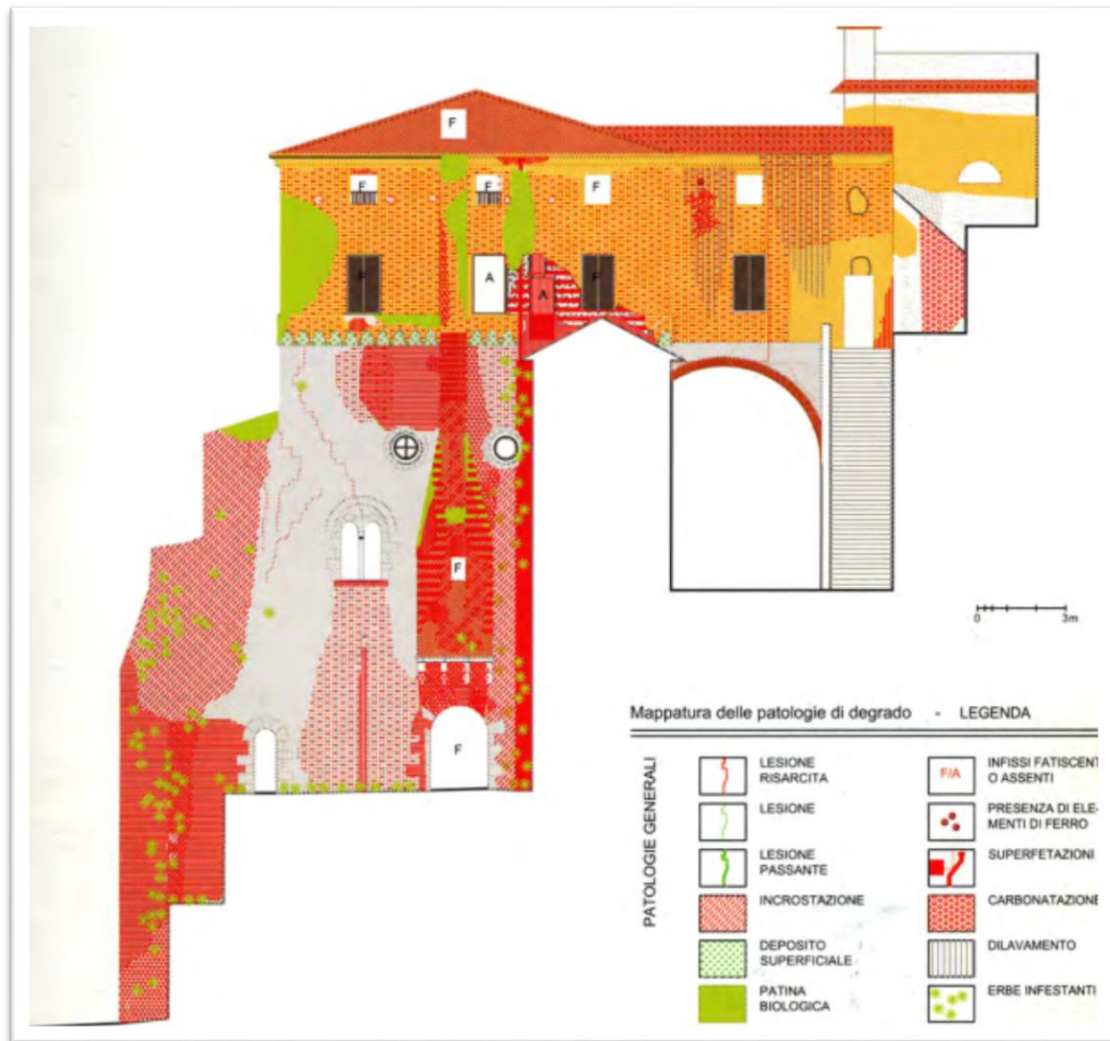
Figure 16: Exemple d'une carte de lésion, façade de castello Basso di Piglio (Frosone), Source: CARBONARA Atlas, Trattato di restauro Architettonico
