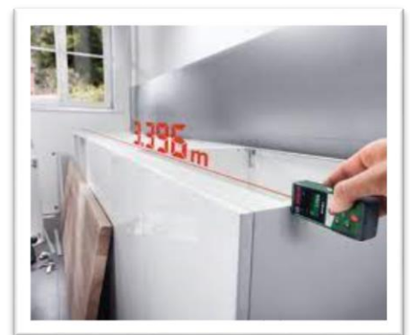
Figure 4: Relevé métrique par télémètre, Source : lianceachat.fr
