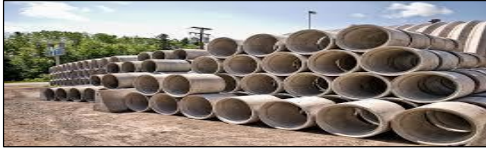
Figure (I-07) : conduites en béton armé.
