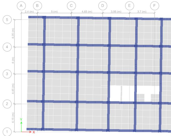
Figure IV. 4. Mode 2 de déformation (translation suivant l'axe X-X).
