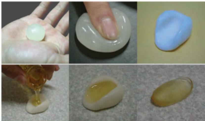
FIGURE 1.16 – Réalisation d'une empreinte digitale artificielle directement à partir d'un doigt vivant [1].
