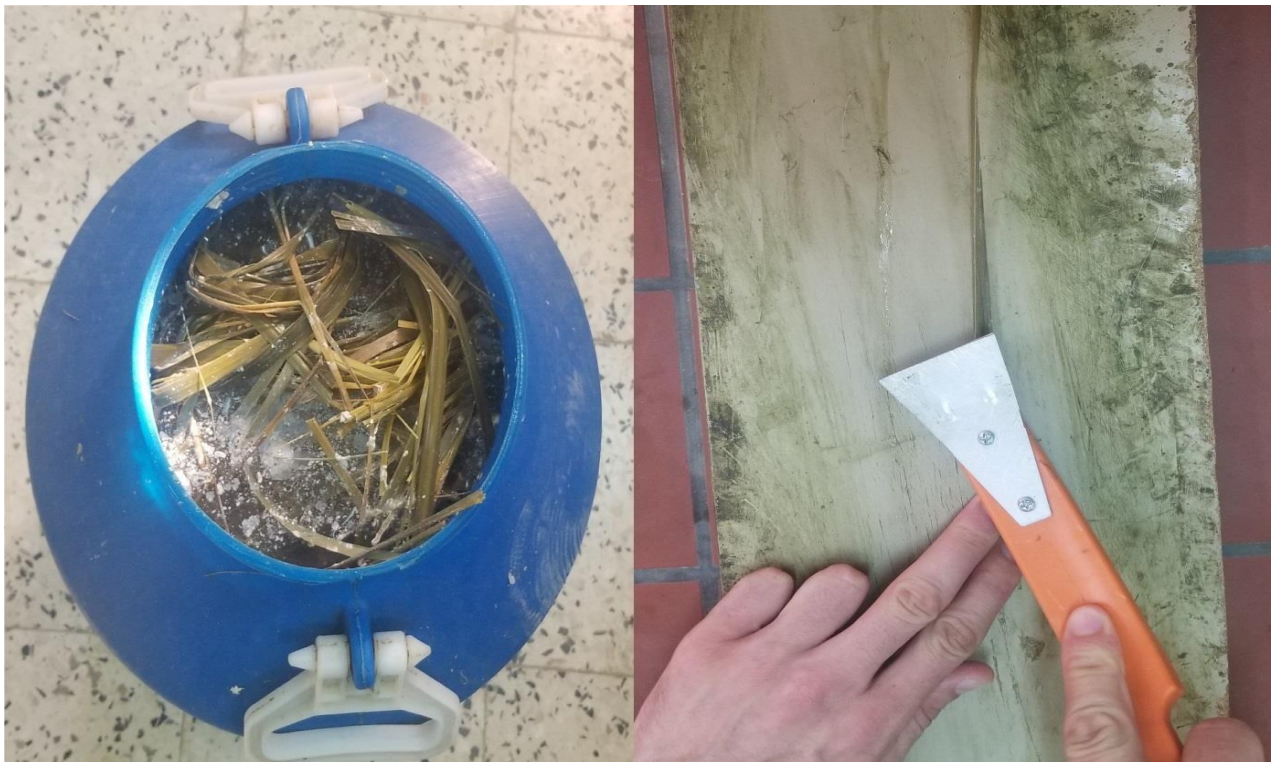
Figure II.2 : Rouissage biologique (à gauche) et l'extraction mécanique des fibres (à droite)
