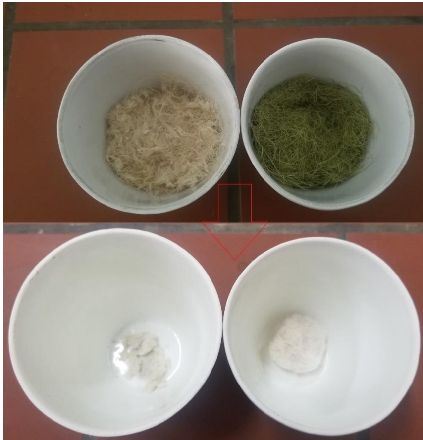
Figure II.7 : Fibres de DISS avant et après la combustion
