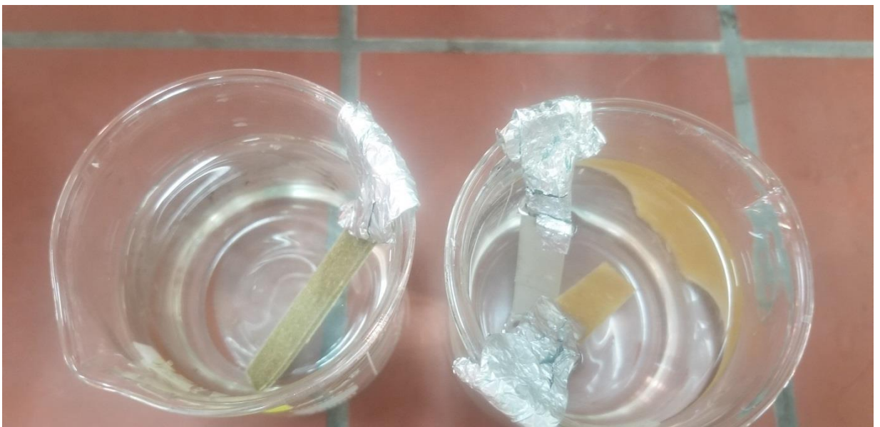
Figure II.14 : Test d'absorption de l'eau par les éprouvettes PP, PP+DNT et PP+DT
