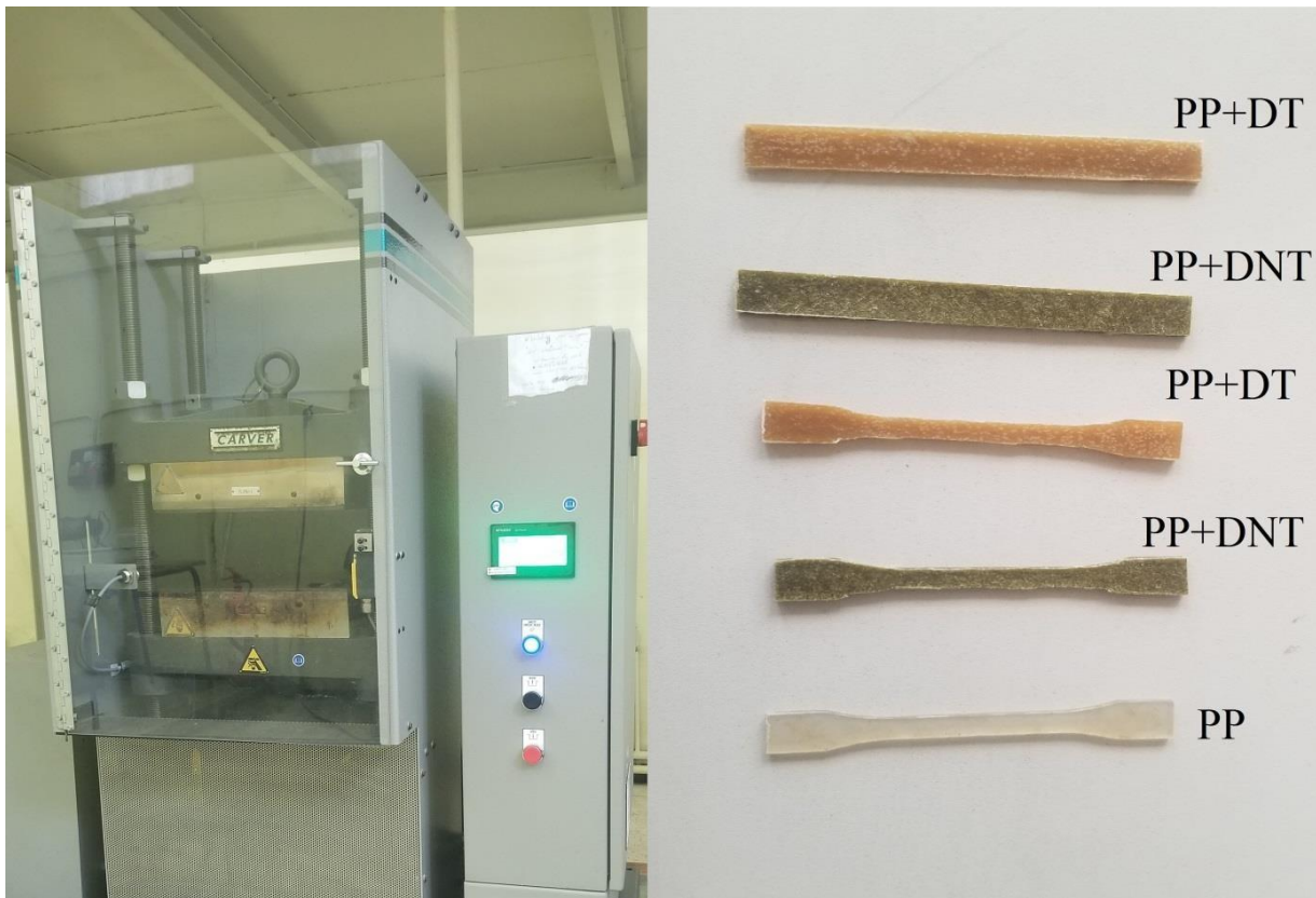
Figure II.6 : Presse hydraulique de marque CARVER (à gauche) et les éprouvettes obtenues (à droite)
