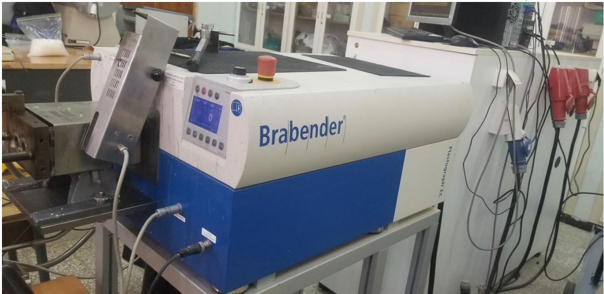
Figure II.5 : Plastographe de marque Brabender
