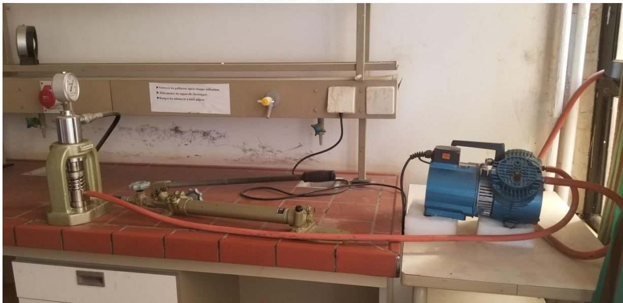
Figure II.8 : Appareil de compression des fibres de DISS pour obtenir des pastilles
