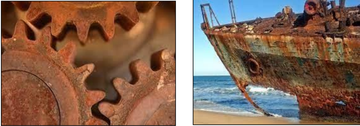
Figure I.1: Photos de matériaux soumis aux phénomènes de corrosion [5].
