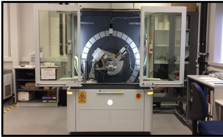
Figure.II.10: Photographie d'un diffractomètre de type Panalytical Empyrean®
