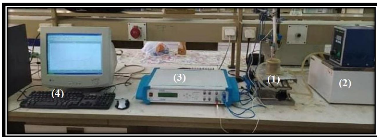
Figure II.7: Dispositif expérimental de mesure potentiodynamique, potentiostatique et galvanostatique
