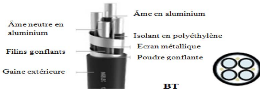
Figure I. 8: Les câbles Souterraines BT
