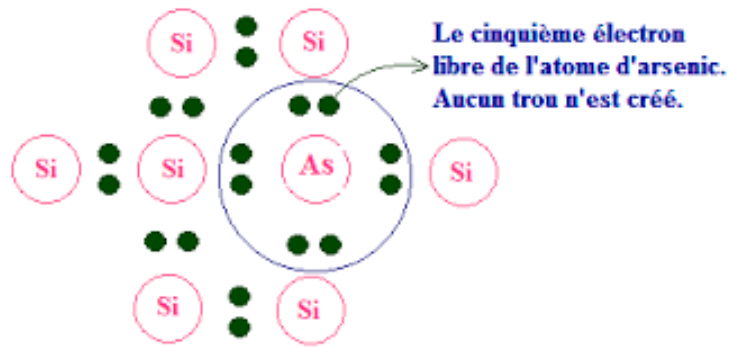
Figure I.8 : Schéma représentatif du semi-conducteur Silicium dopé N par des impuretés d'arsenic [16].
