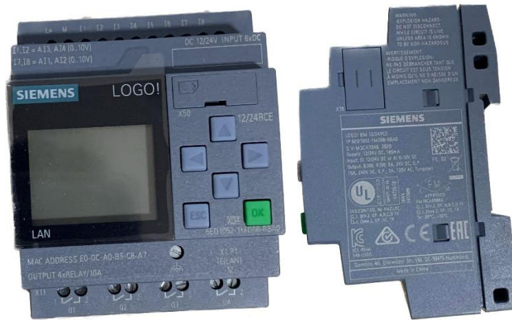
Figure I.13 : Illustration en image d'un module de programmation LOGO Logic.
