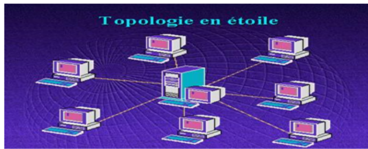
FIG. 1.2 – Topologie en étoile.
