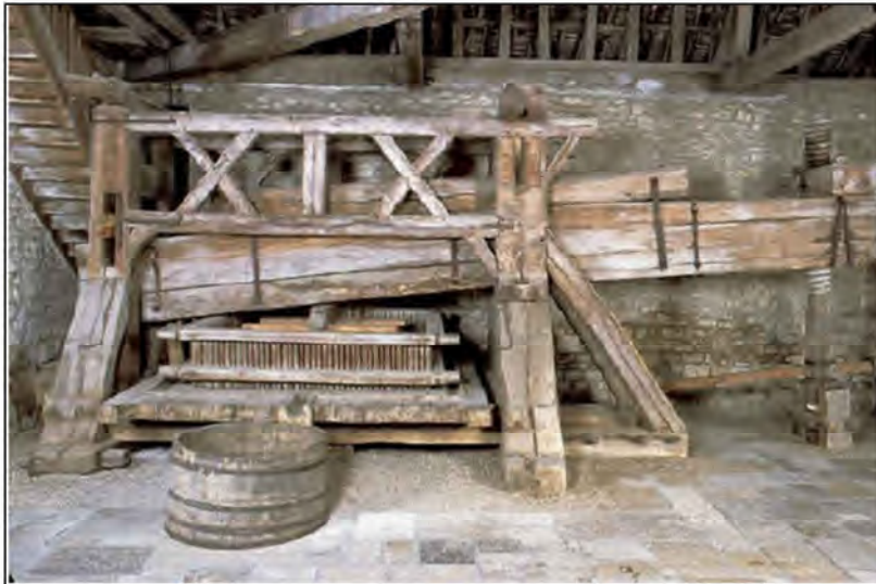
Figure17: Pressoir à levier du château de Clos Vougeot. Source: La chronique du musée des Berthalais : le pressoir/septembre 2016.
