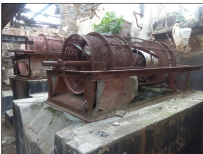
Photo 13 : Pressoir horizontal, intérieur de la cave, Domaine Djebel louze .Amizour.
