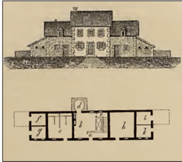
Figure 2 : Plan et élévation d'une ferme à un seul corps de bâtiment. Source : Bouchard-Huzard, Louis. Traité des constructions rurales . Ed 1, 1982, P624.
