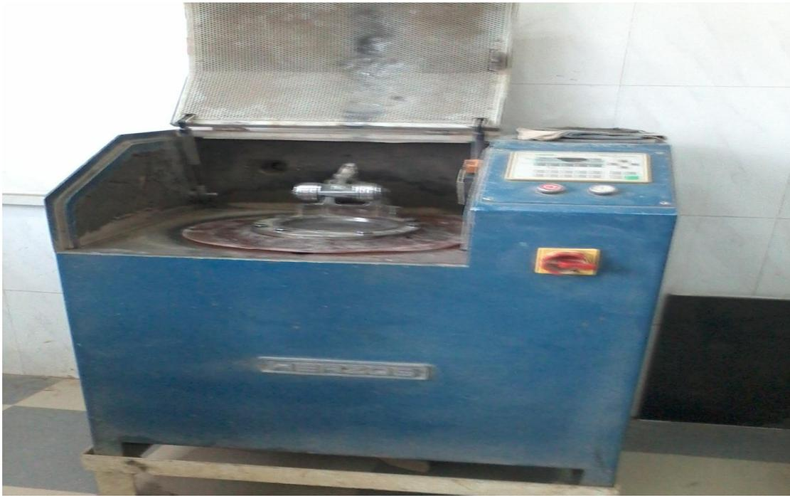
**Figure II.2 :** Broyeur à disque.
