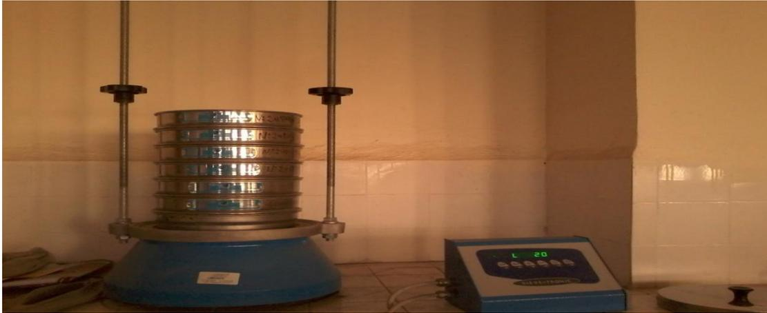
**Figure II.3 :** Tamiseuse avec une série de tamis de norme AFNOR.
