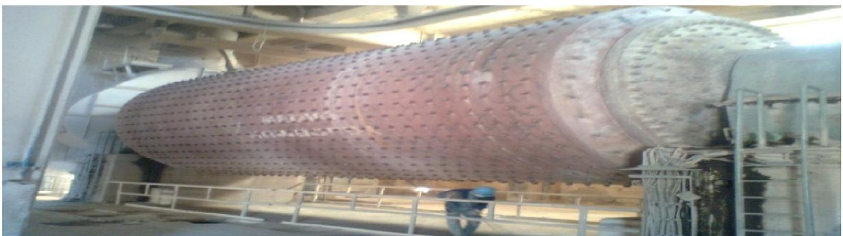
**Figure. I.5** : Broyeur à boulet.
