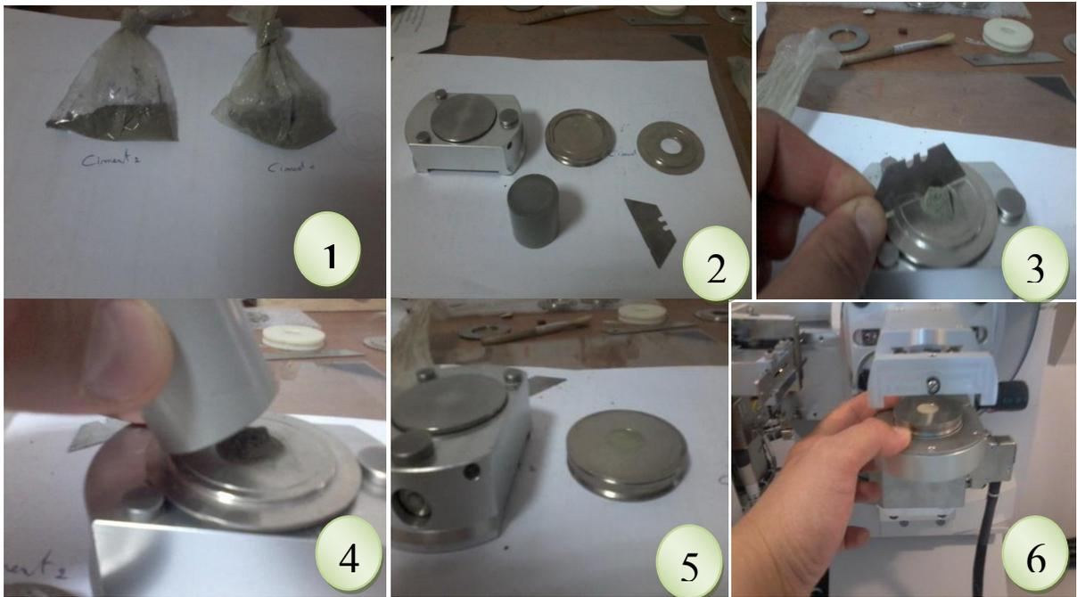
**Figure II.7 :** Les étapes d'analyse par spectromètre de détraction des rayons X.
