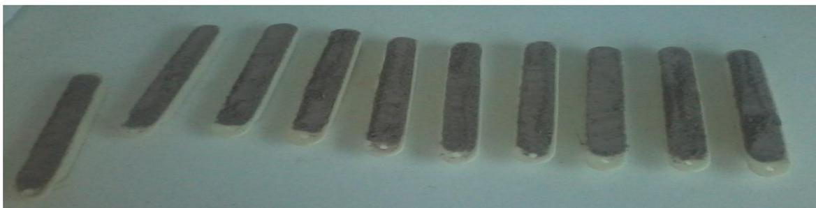
**Figure II.10** : Les creusets en alumine (Al<sub>2</sub>O<sub>3</sub>).
