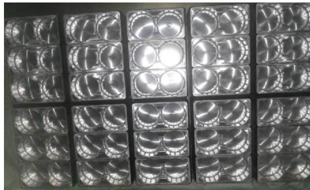
Figure III.4 : Moule a deux cavités d'emballage de biscuit.
