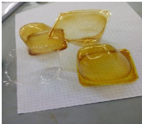
Figure V.8: Quelque essai de thermoformage.
