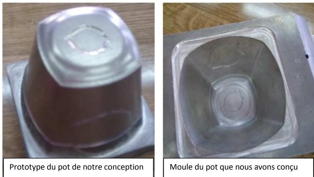
Figure IV.6: Prototype du Potet le moule fini de notre conception.
