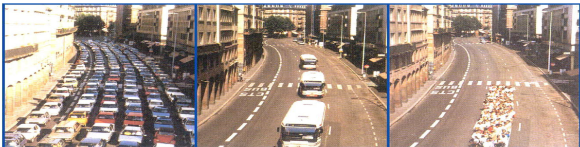
Figure N° 3.7: Comparaison entre la capacité du tramway et les autres modes de transport
