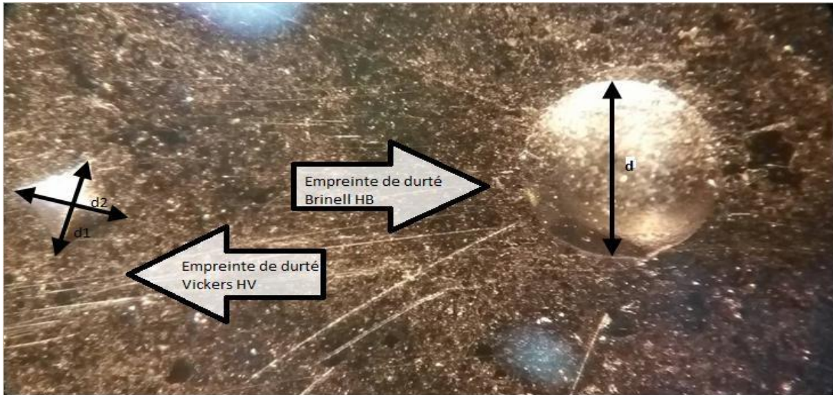
Figure III.6 : Les empreintes Vickers et Brinell
