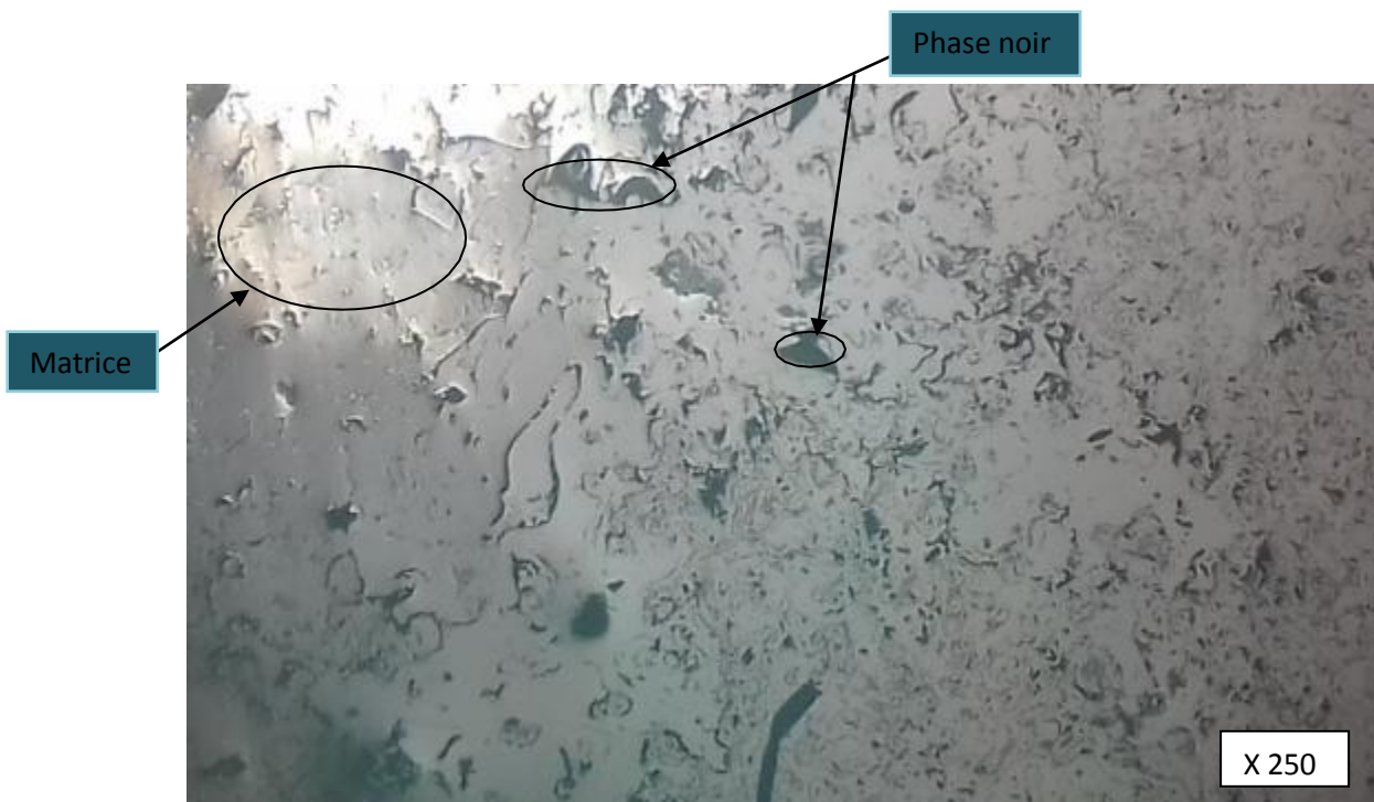
Figure III.3 : Microstructure du dépôt traité à 1100°C
