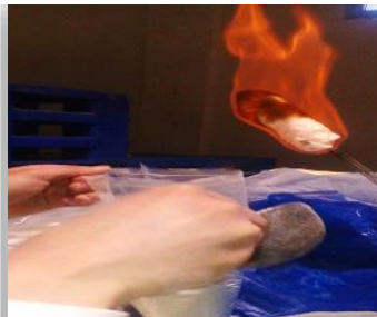
Figure 5 : Photographie de l'échantillonnage de la poudre du lait
