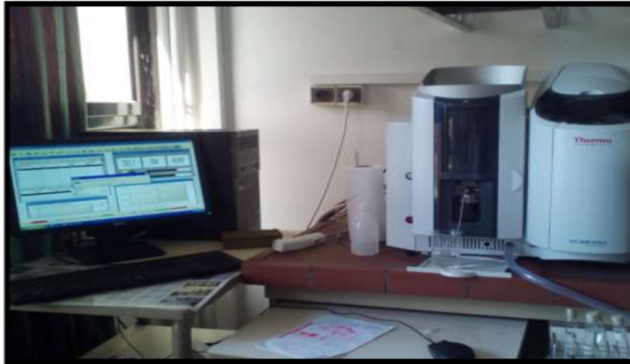
Figure 11 : Spectrophotomètre d’Absorption Atomique a flamme (SAA, F) (Laboratoire de chimie, 2017).
