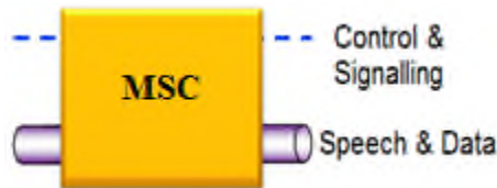
Figure I.3 : Les échanges du commutateur MSC.
