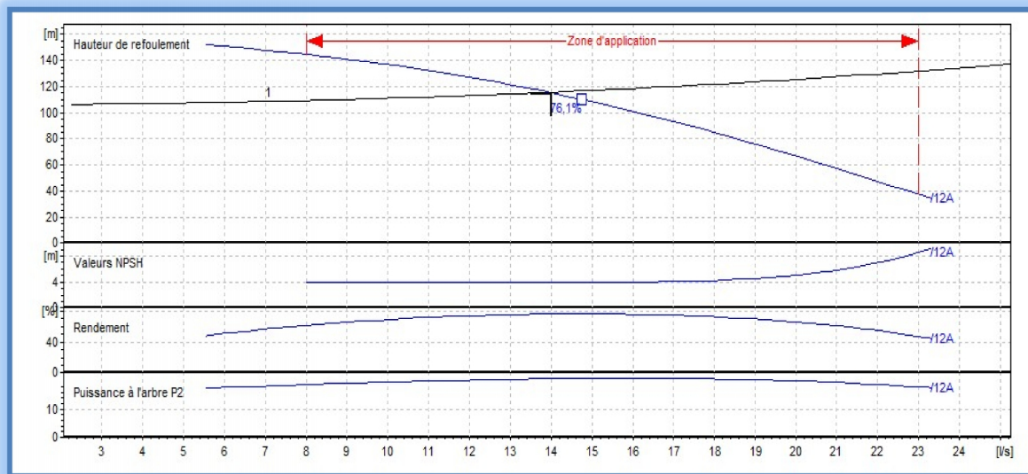
Figure (V-10) : Les courbes caractéristiques de la pompe F4
