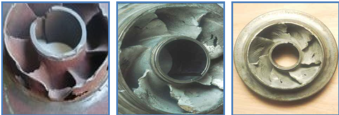
Figure (V-7) : Le phénomène de cavitation sur des aubes de pompe centrifuge.
