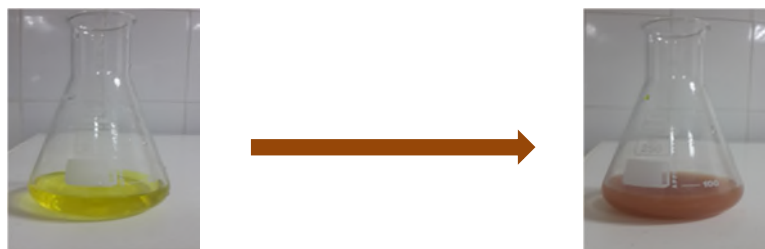
Figure 10 : Dosage des chlorures, après l'ajout de K_2CrO_4 (gauche) et après l'ajout de AgNO_3 (droite)
