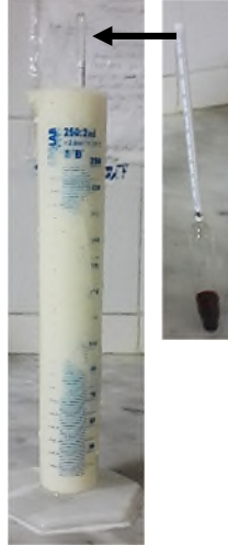
Figure 5 : principe de mesure de la masse volumique à l'aide d'un lactodensimètre.
