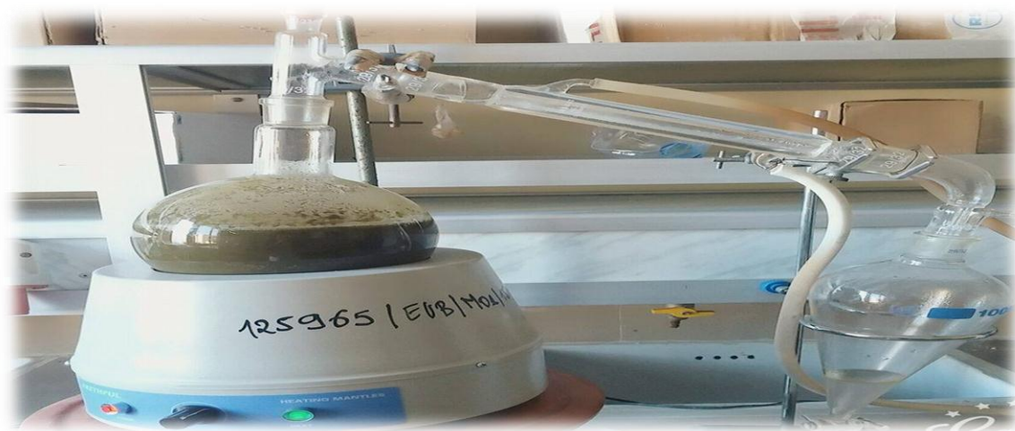
Figure 06 : Dispositif d'hydrodistillation utilisé à l'échelle du laboratoire.
