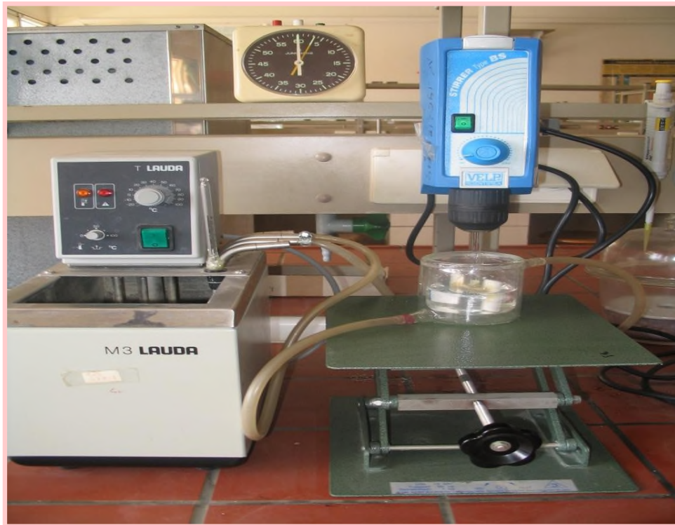
Figure (II. 7) : Schéma du dispositif utilisé pour les opérations d'adsorption.
