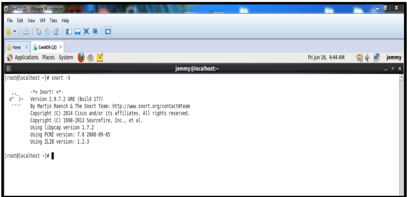
Figure IV.4 : Verification de l'installation de Snort.
