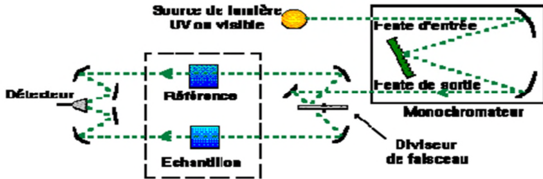
Figure.II.7 : Schéma de principe d'un spectromètre d'absorption UV-visible double faisceau. [60].
