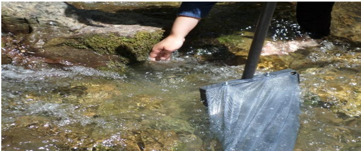
Figure –10- Méthode d'échantillonnage des Gammaridea « kick simpling »
