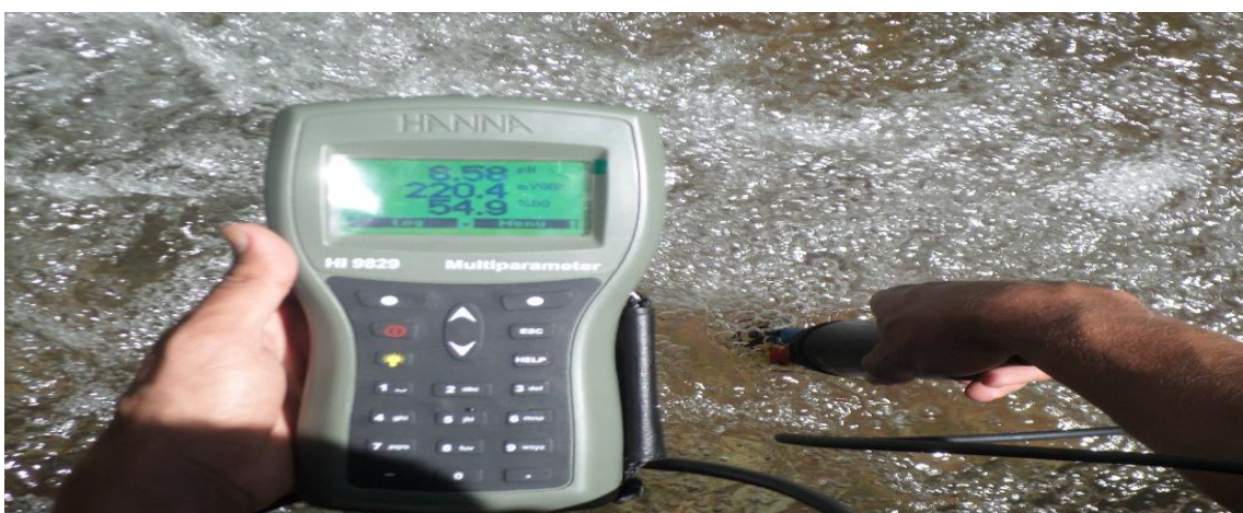
Figure-5- Mesure des paramètres d'eau de cascade avec un multi-paramètre HANNA HI 9892
