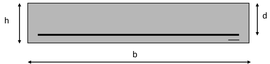
Figure III.12 : Section à ferrailer.
