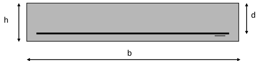
Section à ferrailer.
