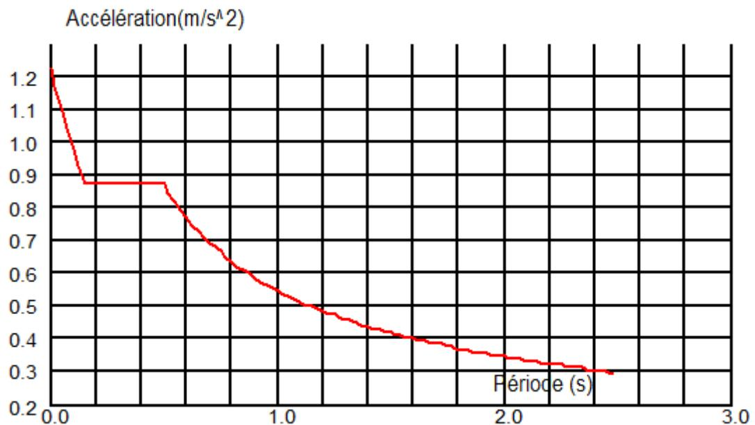
Figure VII. 2: Schéma du spectre de réponse suivant Y.
