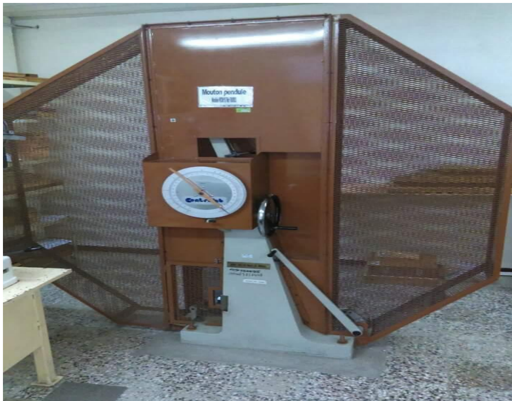
Figure II.3. Mouton pendule Charpy de capacité 300J
