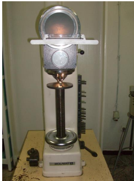
Figure II.5. Machine de dureté universelle Brinell, Vickers et Rockwell de l'UGB
