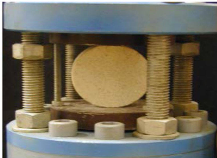
Figure II.9. Dispositif expérimental(Essai Brésilien)[4].
