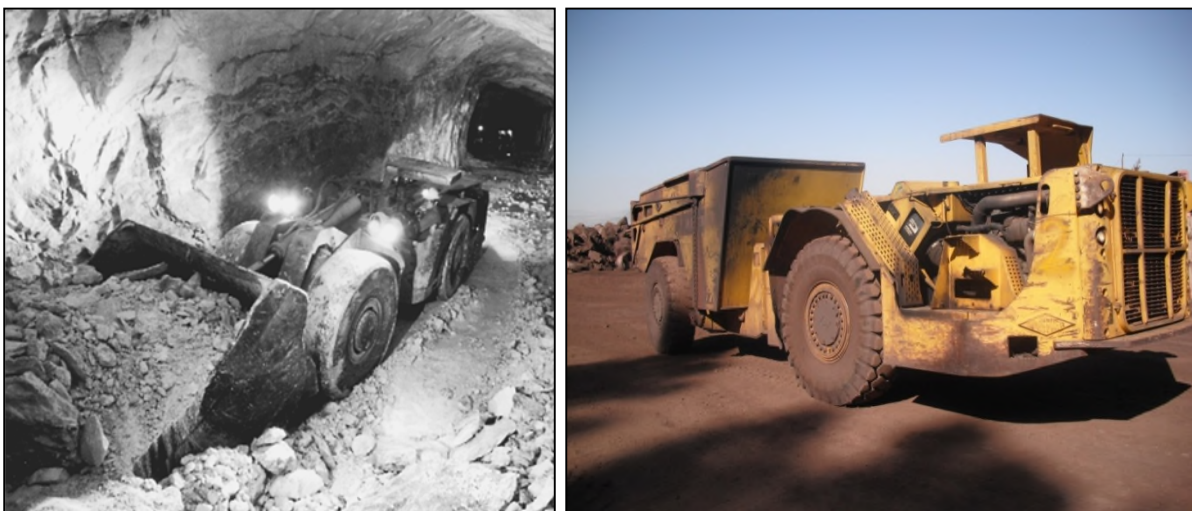
Figure IV.9. L'opération de chargement et de transport dans le fonds [15].
