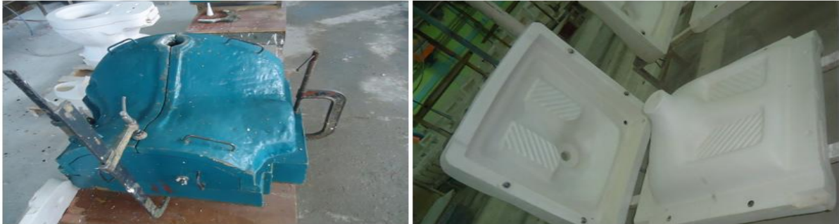
Figure II-1 : Fabrication des moules mères
