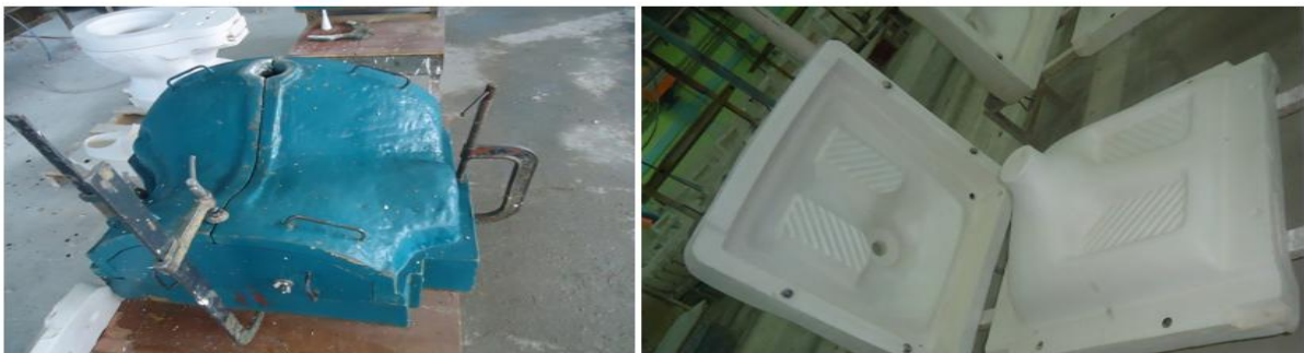
Figure II-1 : Fabrication des moules mères
