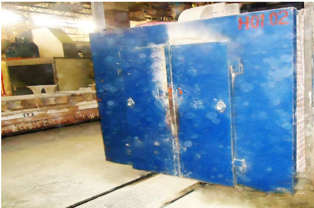
Figure III.14 : Four tunnel électrique
