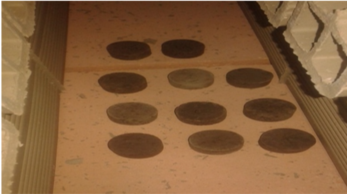
Figure II.3 : les échantillons dans le four à 900°C.
