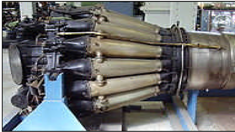
Figure. 26 : Chambres de combustion
