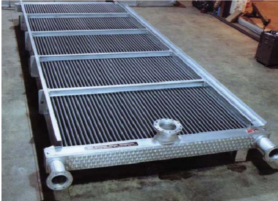
Figure II-9 : Photographie d'un faisceau tubulaire avant montage sur site
