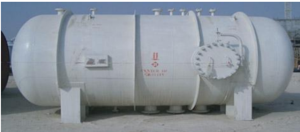
Figure II-14 : Photo d'un ballon de récupération des condensats
