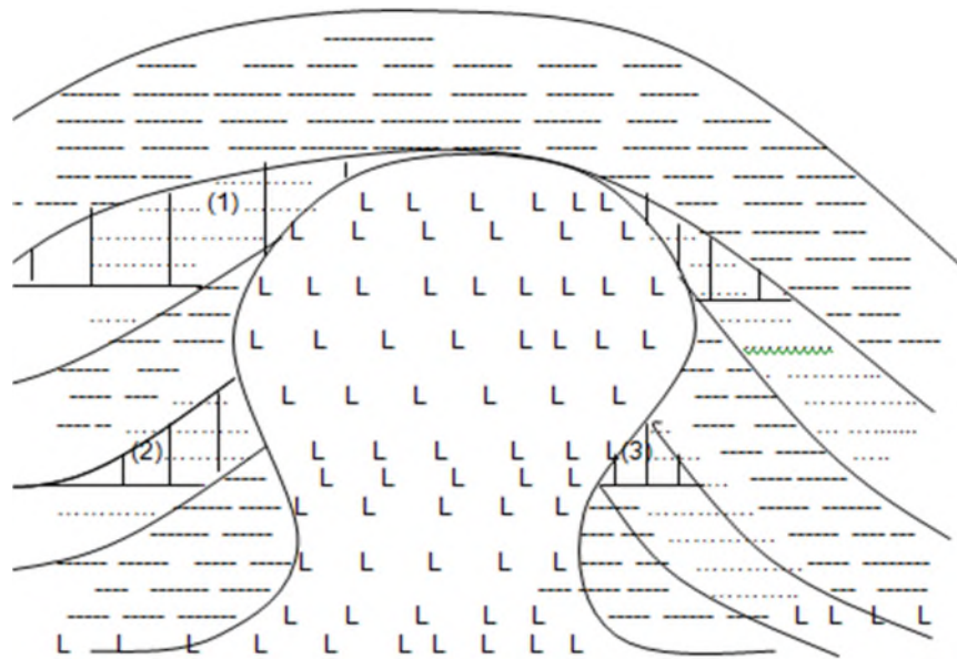
Figure II.26 : piège lié à un dôme de sel.
