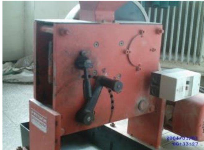
Figure II.5. Concasseur de type Fritsch. (Laboratoire LTPG)
