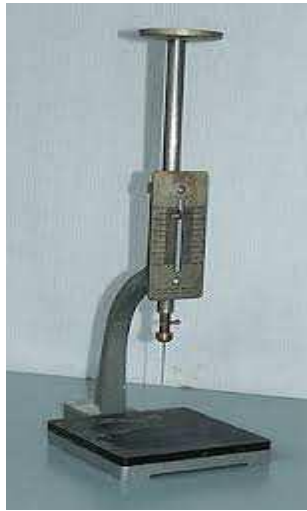
Figure II.19. Appareil de Vicat. Laboratoire gène civile.
