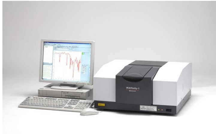
Figure II.10. Image de l'appareil du spectrophotomètre IR. laboratoire gène de procédé II.3.3. Spectrométrie d'émission de fluorescence X (QCX)
