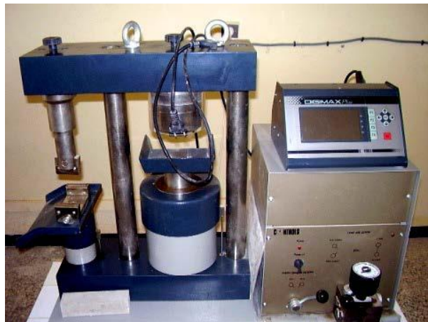
Figure II.18. Machine de compression et flexion sur les ciments (Control) type 65-113M1.
