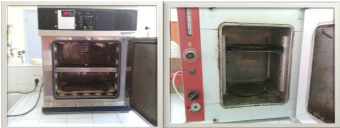
Figure II.1. Boue dans l'étuve à 105°C. Figure II.2. Boues dans étuve à 50°C.
