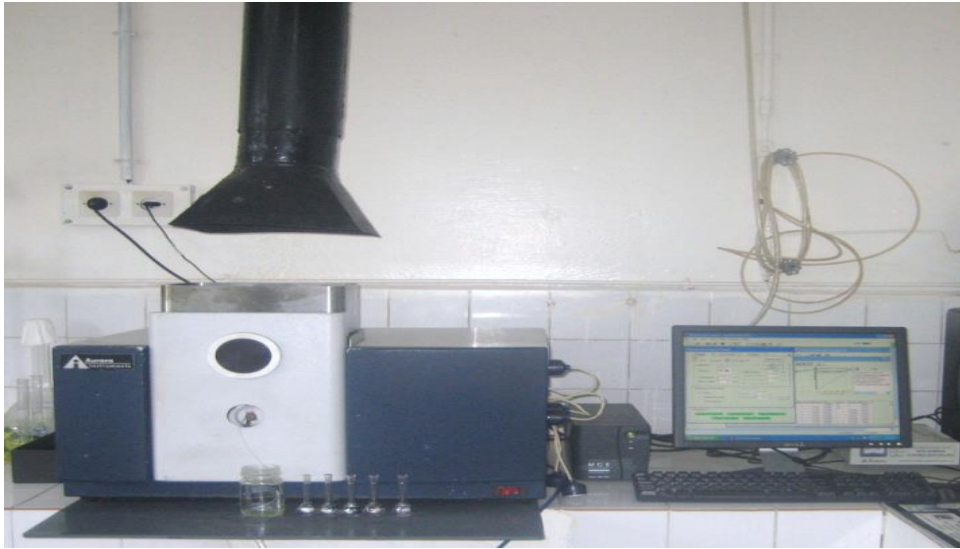
Figure II.13. Photo de l'appareille du spectrophotomètre d'absorption atomique. Laboratoire gène de procédé.
