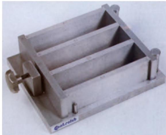
Figure V.1. Moule utilisé pour la conception des éprouvettes des différentes pates.
