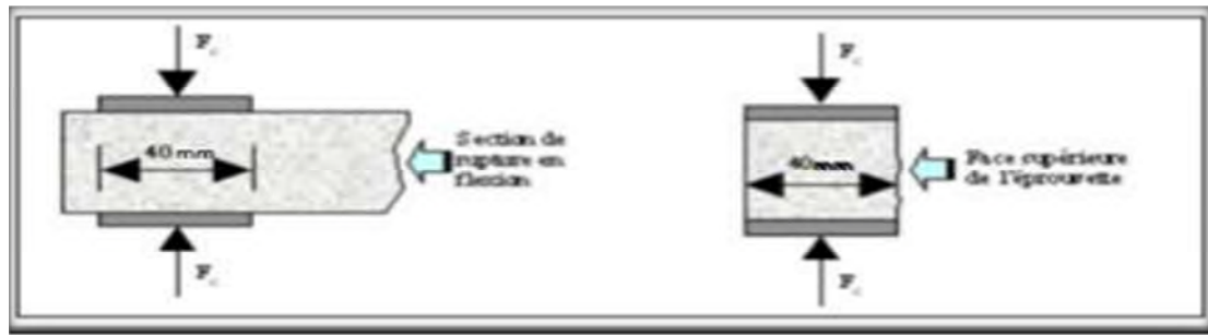
Figure IV.3. Dispositif pour l'essai de résistance à la compression
