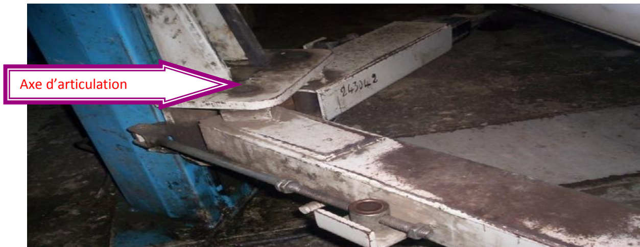
Figure 15: axe d'articulation des bras télescopique (SIMB Bejaia).
