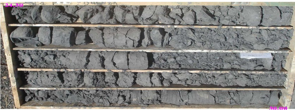
05 Caisses à carottes du premier sondage (30m de profondeur)
