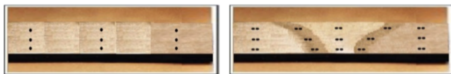
FIGURE 3.15 – Positions des empreintes de la microdureté Vickers.
