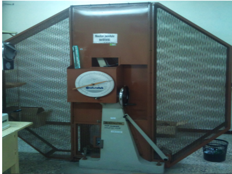
FIGURE 3.11 – Mouton pendule d'essai de résilience.
