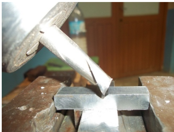
FIGURE 3.9 – Réalisation de l'entaille avec un angle de 45^\circ .
