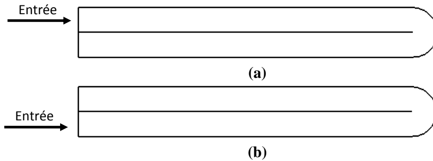
Figure III.14 Illustration du canal d'entrée (a) Entrée par le canal supérieur, (b) Entrée par le canal inférieur
